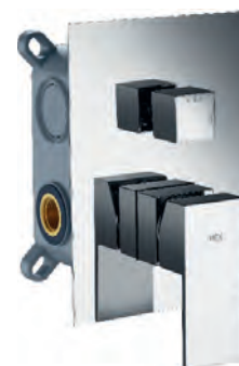
Ref.: GSM04V (cuatro vías) Grifería empotrada monomando, 4 vías. Laton cromado Box de registro. Cartucho cerámico 35mm
