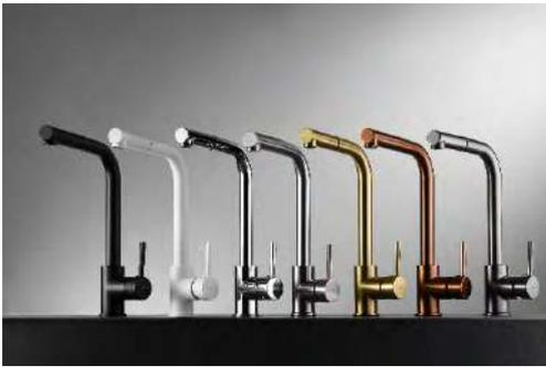
Grifería monomando de cocina con caño extraíble, con cuerpo en latón, cartucho monomando Ø35mm, que incluye latiguillos de 50cm para su instalación.
