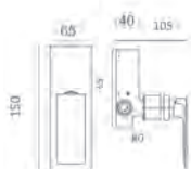
Ref. : GSM03V (tres vías) Grifería empotrada monomando, 3 vías. Latón cromado Box de registro. Cartucho cerámico 35mm
